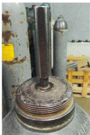
Fot 1. Sposób zamocowania sprawdzianu w otworze gwintowanym butli
