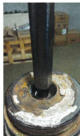
Fot. 3. Wskazanie dla gwintu niespełniającego kryterium akceptacji
