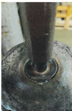
Fot 2. Wskazanie dla gwintu spełniającego kryterium akceptacji
