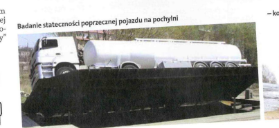
Badanie stateczności poprzecznej pojazdu na pochylni
