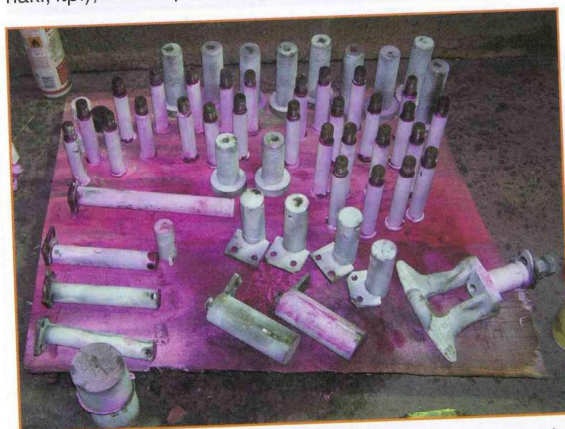
Rys. 6 Badanie penetracyjne sworzni i osi elementów wyciągu narciarskiego
