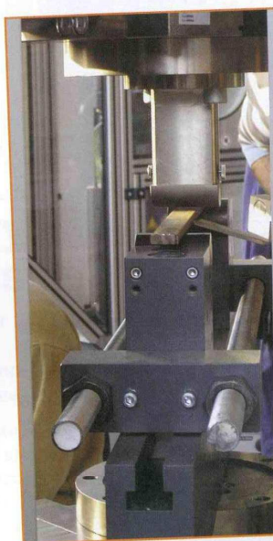
Rys. 6 Badanie penetracyjne sworzni i osi elementów wyciągu narciarskiego
